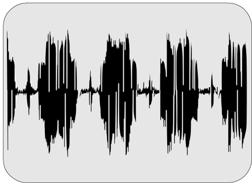
③① A-Board A26 Pin 20 - 1.00V p-p COMB-C
